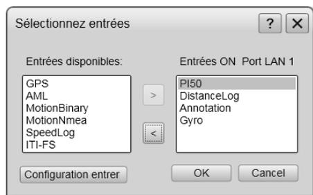
Si les paramètres de communication d'entrées ont besoin d'être réglés, cliquez sur le capteur d'entrée pour le sélectionner, puis cliquez sur la touche **Configuration entrée**. Le cas échéant, la boîte de dialogue correspondante s'ouvrira.
