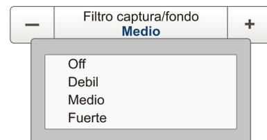
Cuando el filtro *Fuerte* se aplica, el cambio en el estado debe durar y permanecer estable por lo menos ocho transmisiones del sensor antes de mostrar la actualización en la pantalla del PI50.
