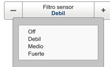
El filtro de sensor ofrece cuatro ajustes diferentes. El filtrado *Leve* promediará los datos recibidos por la cuatro últimas transmisiones del sensor, mientras que el filtrado *Fuerte* promedia los datos recibidos por las últimas 16 transmisiones.
