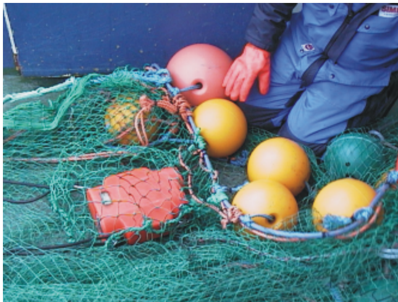
Figure 8 - Her er Tråløyet montert på M/S Simrad's bunntrål
