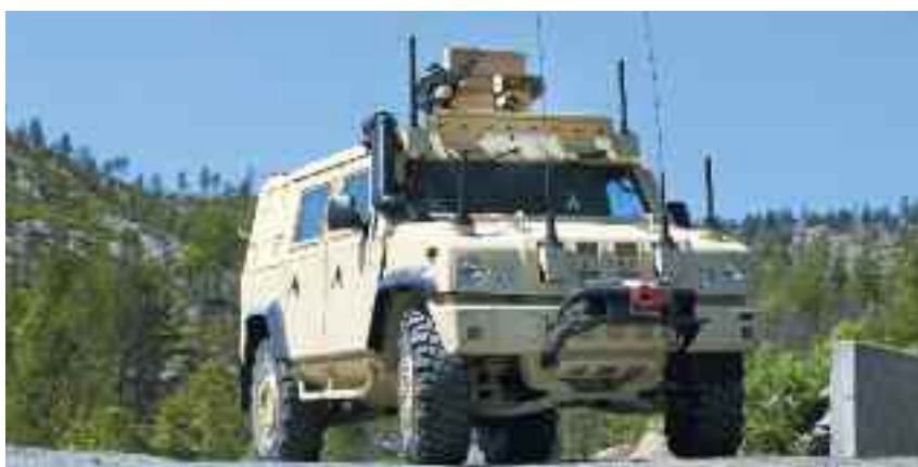
Prinsippet for KONGSBERGS våpenstyringssystem Protector er at våpen og sensorer er montert på utsiden av kjøretøyet, mens operatøren fjernstyrer systemet fra en beskyttet posisjon inne i kjøretøyet.
